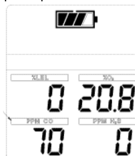
Figura 3-8. Instrumento en alarma de gas tóxico
