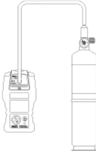
Figura 5-4. Ajuste de calibración típica para instrumentos de difusión con cápsula de calibración
