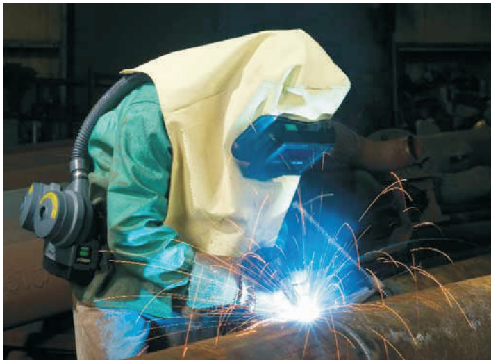
Ilustración 5. Solución de protección respiratoria con capucha, lente fotosensible y PAPR
