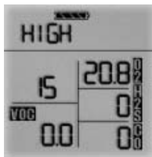
Figura 3-5a: El instrumento en la alarma de LEL
