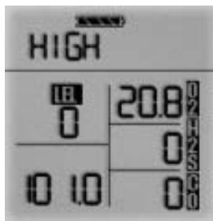
Figura 3-7a: El instrumento en la alarma de gas VOC
