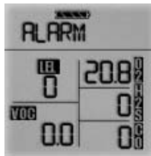
Figura 3-4b: Alarma de la bomba en la pantalla
