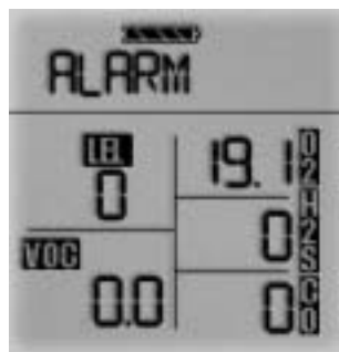
Figura 3-6b: El instrumento en la alarma de oxígeno
