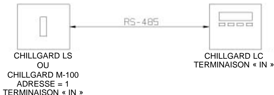
Figure 1-3. Connexion des capteurs et LC à l'aide des communications RS-485
