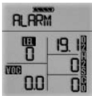
Figure 3-6b. Instrument en alarme d'oxygène
