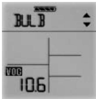
*Figure 3-16. Changement du type d'ampoule*
