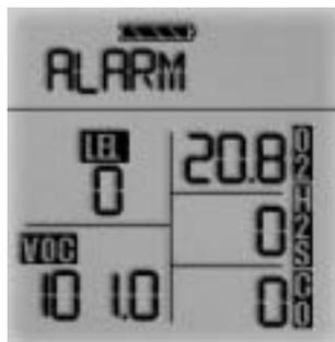
**Figure 3-7b. Instrument en alarme COV**
