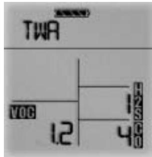
*Figure 3-13. Page d'exposition avec alarme MPDT (TWA)*
