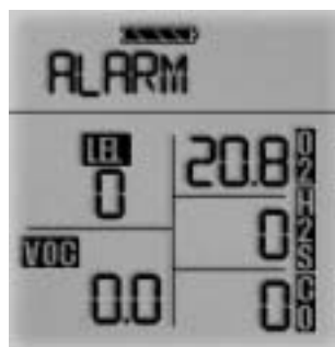
Figura 3-4b: Alarma de la bomba en la pantalla
