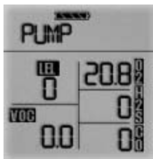
Figura 3-4a: Alarma de la bomba en la pantalla
