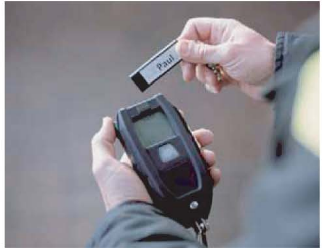
alphaWRITER - α 读写器 通过智能化的软件程序对独立的alphaTAG - α 识别卡 进行编程。
