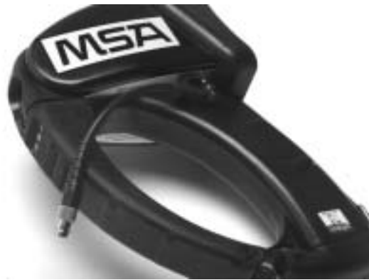
Figura 5: TIC con conector de SMA hacia BNC
